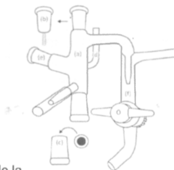
Figura 2. Esquema de la celda electroquímica propuesta
