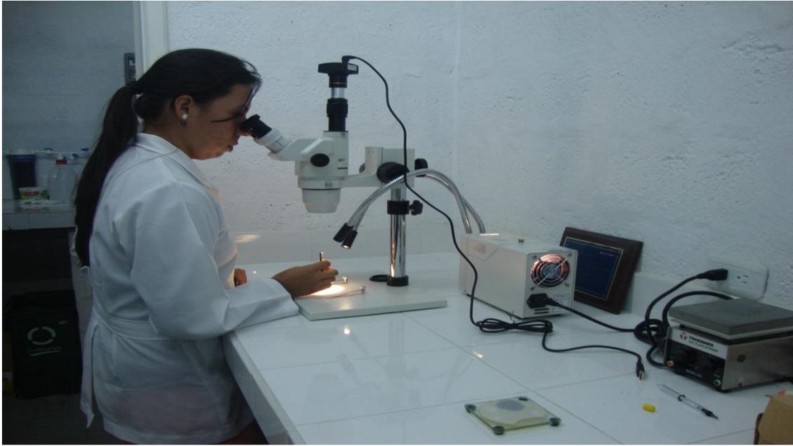
**Evaluación de los electrodos de trabajo por microscopía óptica**
