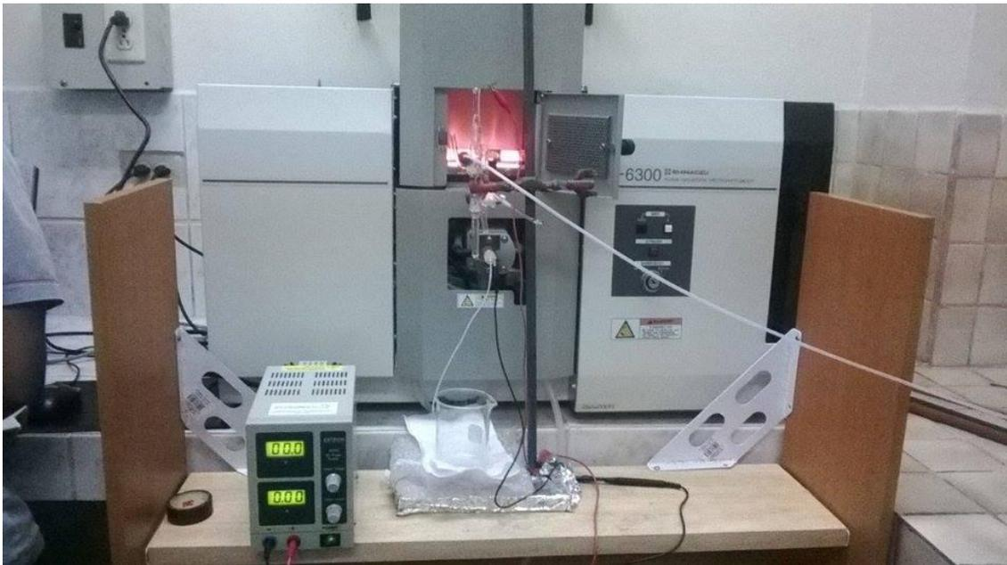
**Sistema Electroquímico acoplado al sistema Espectroscópico**
