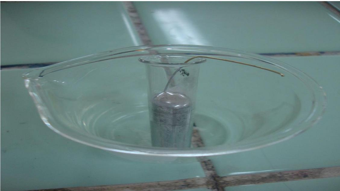
**Proceso de amalgamado del electrodo de Au  $\rightarrow$  Ag**
